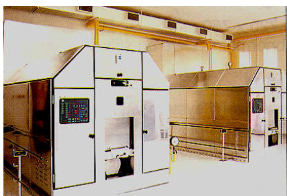
Piec monoblok z dolnym odciąganiem spalin
