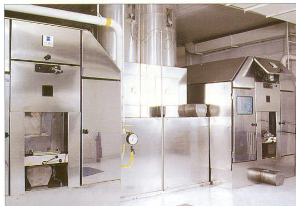
Piec monoblok z bocznym odciąganiem spalin
